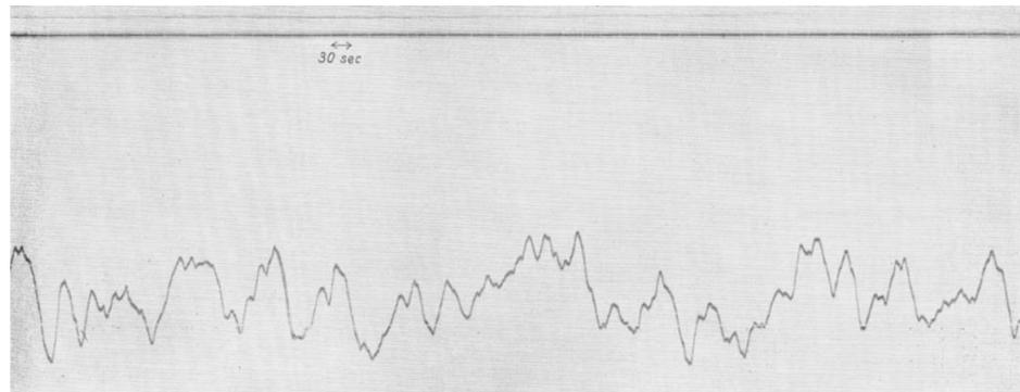
Izquierda: principio del experimento: un haz de luz se refleja en un espejo suspendido de un alambre. Derecha: registro del movimiento del haz de luz. Datos extraídos del artículo: Eugen Kappler, Versuche zur Messung der Avogadro-Loschmidtschen Zahl aus der Brownschen Bewegung einer Drehwaage, Annalen der Physik 11, p. 233 (1931)
