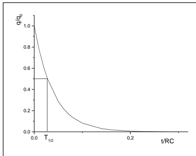
Figura 2. Descarga de un capacitor.
