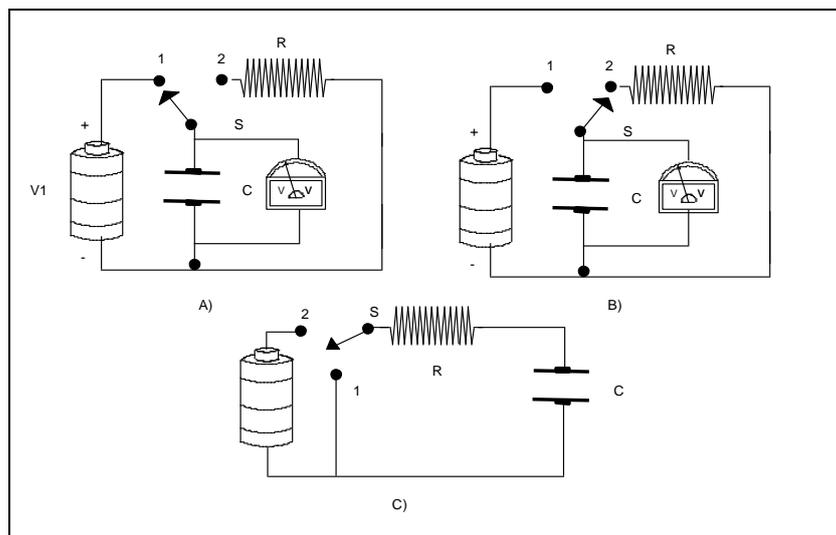
Figura 1. Circuitos para observar la descarga y carga de un capacitor.
